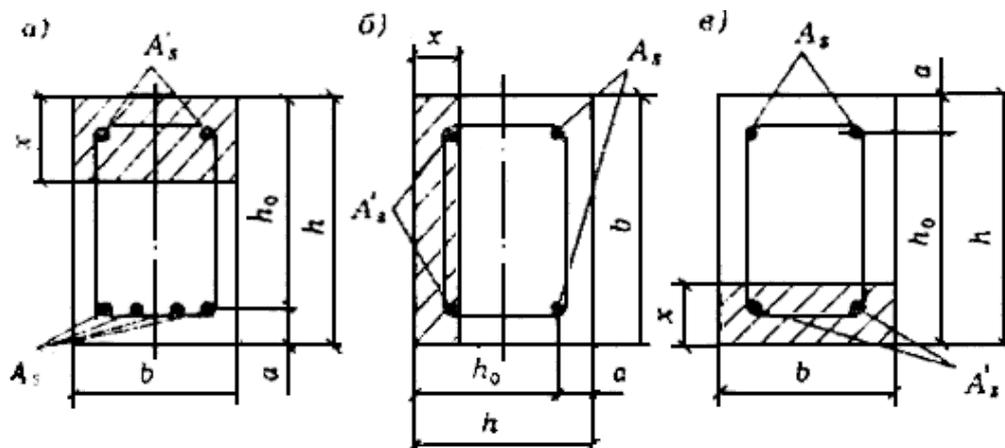
Черт.14. Схема расположения сжатой зоны пространственного сечения
