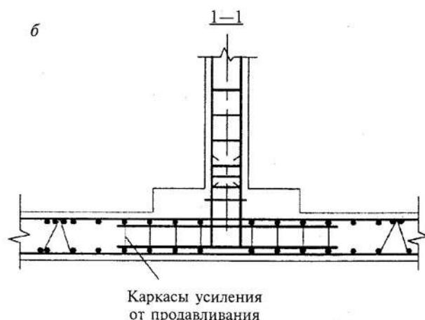
**Рисунок 1.10 — Армирование сплошных плоских фундаментов**
