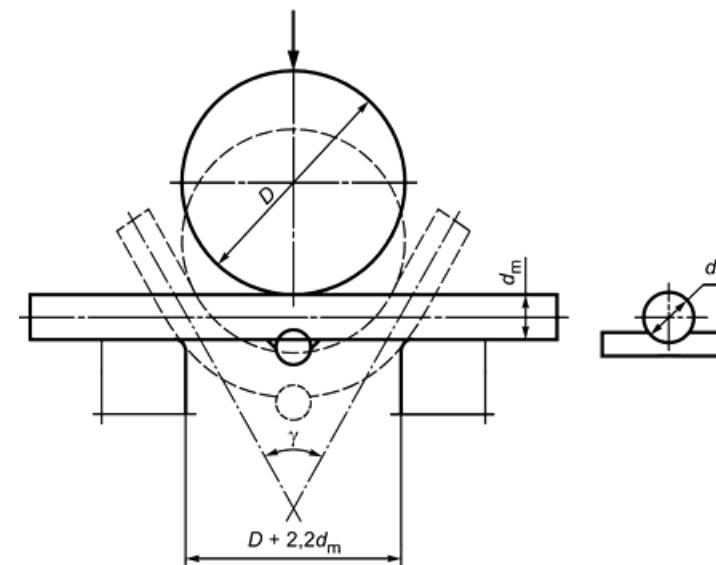
$d_m$  - максимальный диаметр поперечного сечения испытуемого проката
