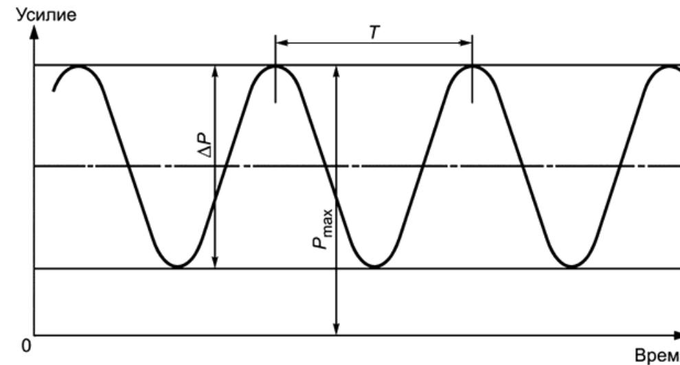
**Рисунок Е.1 - Обозначения параметров повторяющейся нагрузки**
