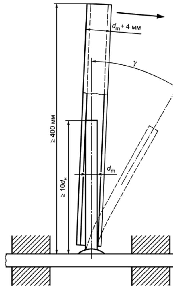
$d_m$  - максимальный номинальный диаметр поперечного сечения испытуемого проката
