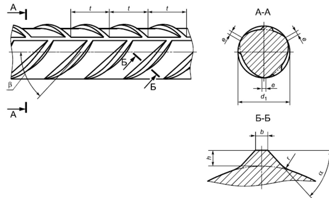
Рисунок 3 - Конфигурация и параметры периодического профиля по форме Зф
